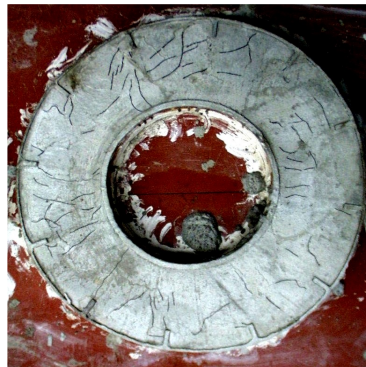
Nullmischung: Starke Schwindrissbildung
